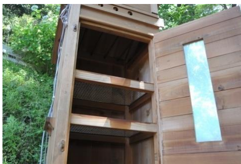
網 4 段、吊パイプ
